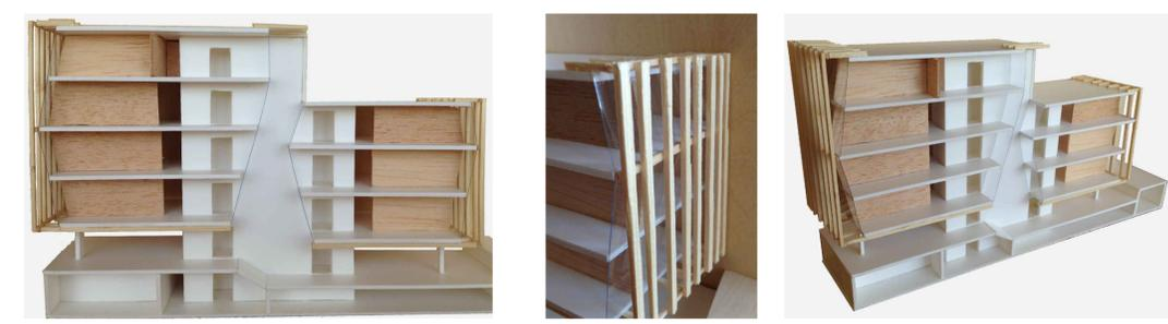
Con la fachada exterior de lamas de madera se busca la continuidad volumétrica, tanto de la manzana como del propio edificio.
